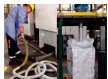
用托盤及中央吸塵系統 收集包裝填充區域散落 之塑膠原粒
