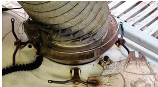
使用含有套筒內襯或布管延伸至槽車裝卸孔
