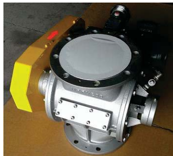
以旋轉式供料閥輸送塑膠粉末，取代虹吸式
