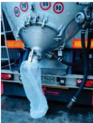
使用塑膠袋套在產品排放孔
