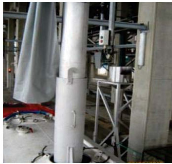
使用密封管線輸送塑膠原粒至載貨卡車
